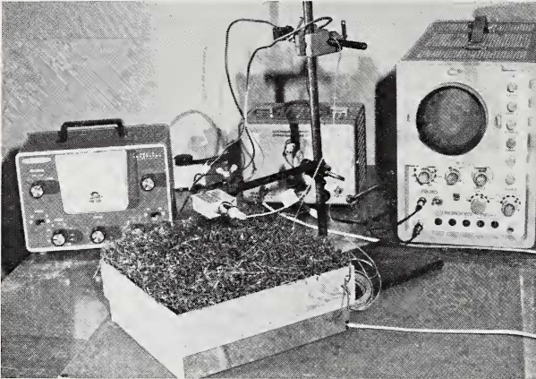
Abb. 2. Apparatur zur Messung der Fortpflanzung von U-Schallwellen im Moos. Vordergrund: Moosbehälter, darunter das Mikrofon (unsichtbar), am Stativ der Lautsprecher; Hintergrund: U-Schallgenerator, Verstärker und Oszillograf
